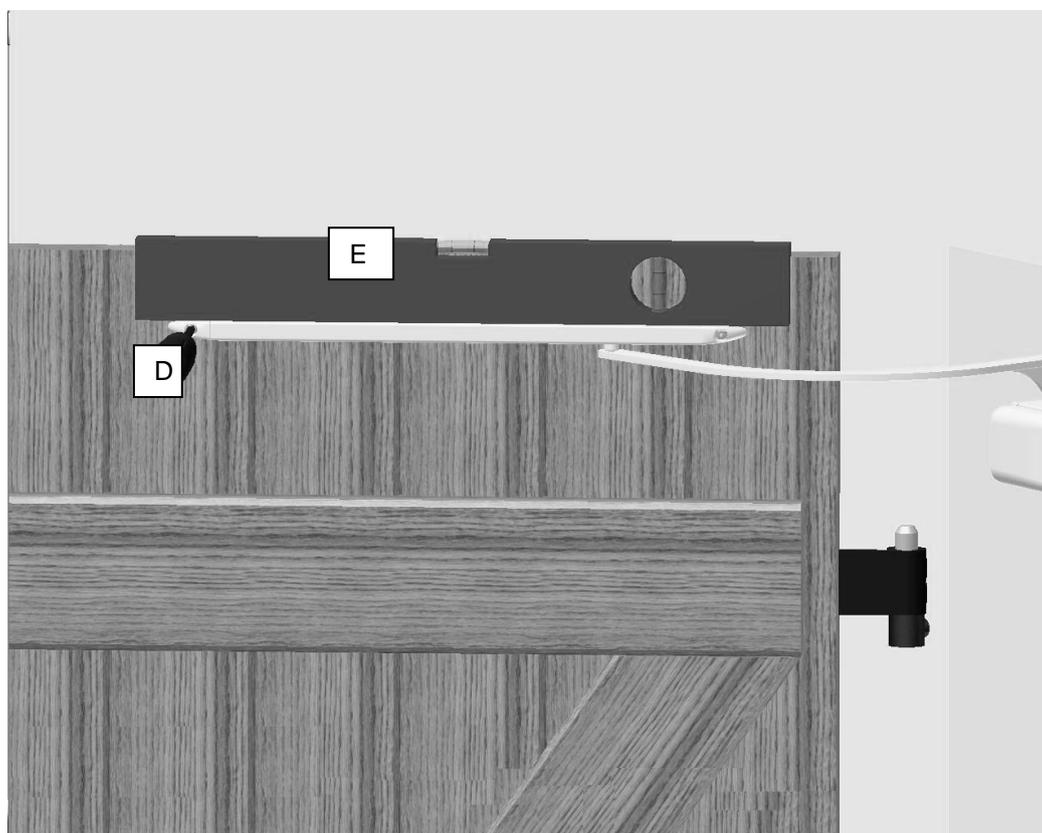
Vérifier la bonne rotation du volet. Le Volet doit s'ouvrir et se fermer sans aucunes contraintes.
