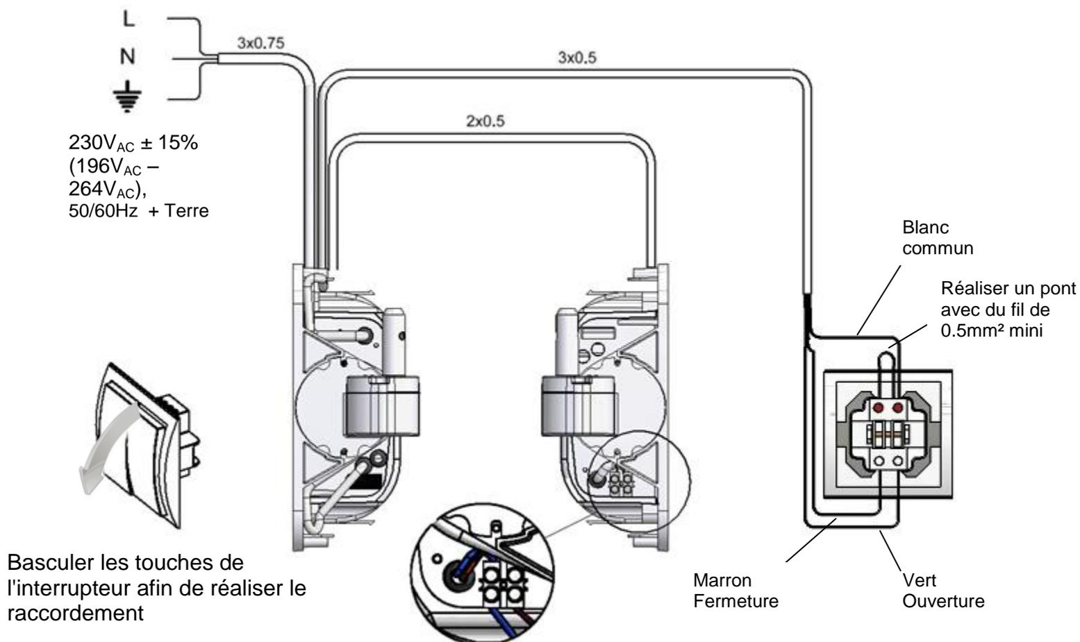
1 Raccorder sur le connecteur « MOTEUR 2 » du second moteur avec le câble 2 x 0.5 en respectant les couleurs des fils déjà branchés sur le connecteur. Bleu sur bleu et marron sur marron.
