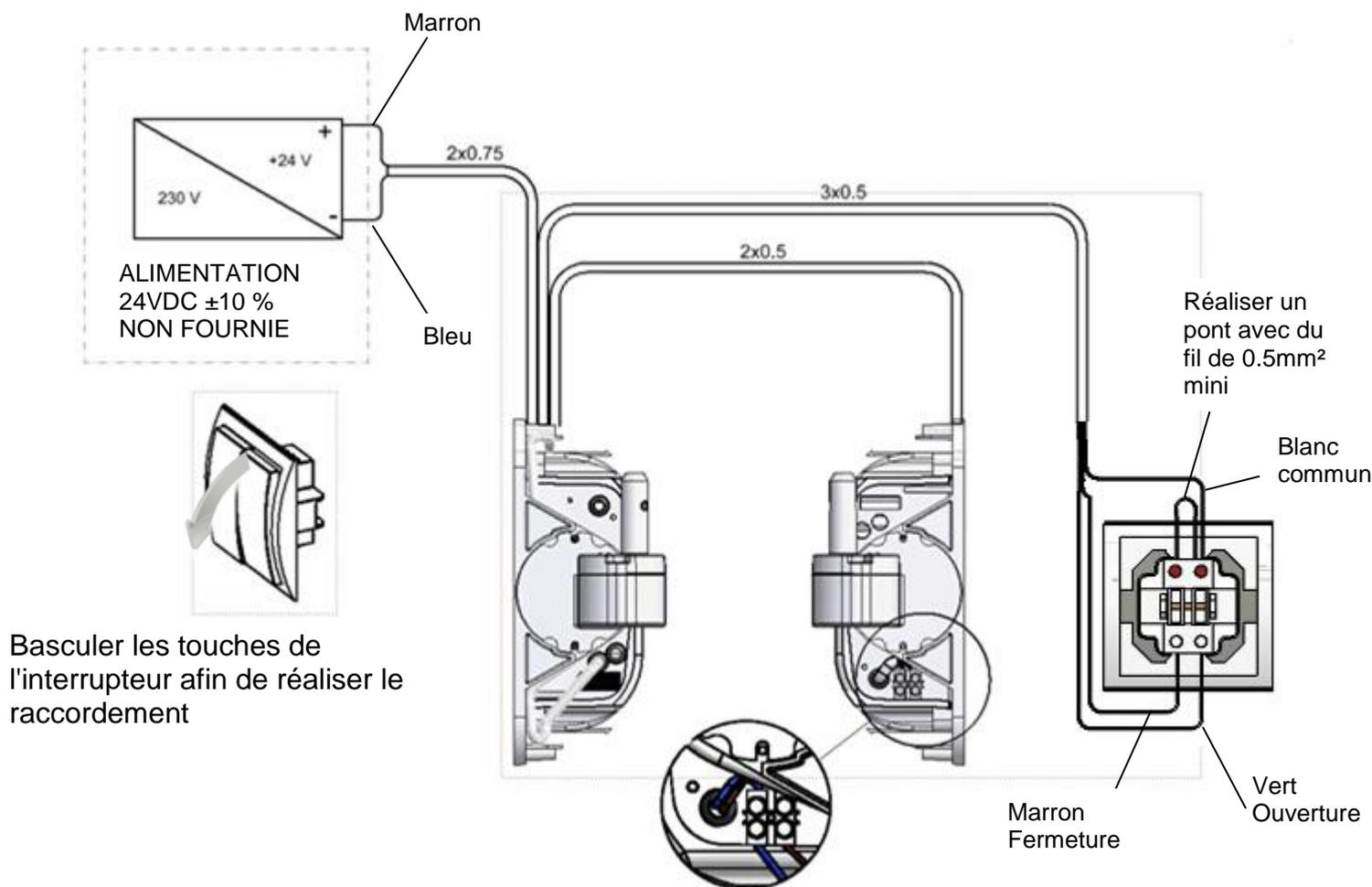
1 Raccorder sur le connecteur « MOTEUR 2 » du second moteur avec le câble 2 x 0.5 en respectant les couleurs des fils déjà branchés sur le connecteur. Bleu sur bleu et marron sur marron.
