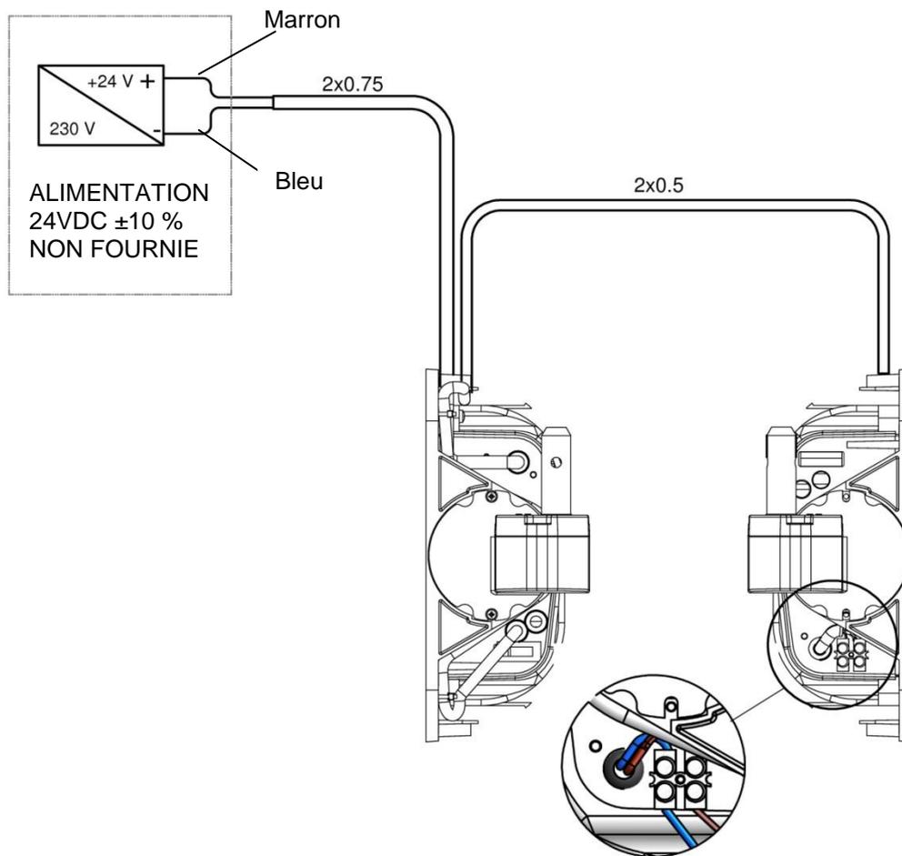
1 Raccorder sur le connecteur « MOTEUR 2 » du second moteur avec le câble 2 x 0.5 en respectant les couleurs des fils déjà branchés sur le connecteur. Bleu sur bleu et marron sur marron.
