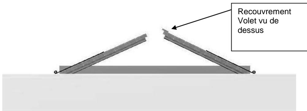
Si le recouvrement est sur l'autre vantail, il faut commuter l'interrupteur.
