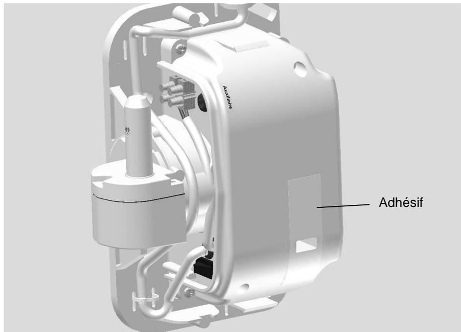
Monter le capotage sur le système puis clipper les 3 caches de masquage.
