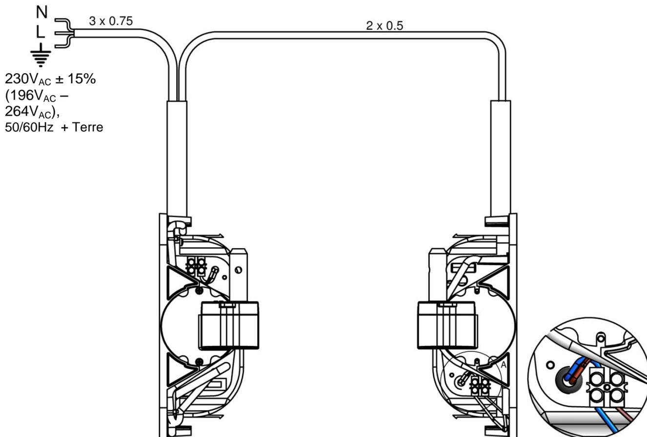
1 Raccorder sur le connecteur « MOTEUR 2 » du second moteur avec le câble 2 x 0.5 en respectant les couleurs des fils déjà branchés sur le connecteur. Bleu sur bleu et marron sur marron.
