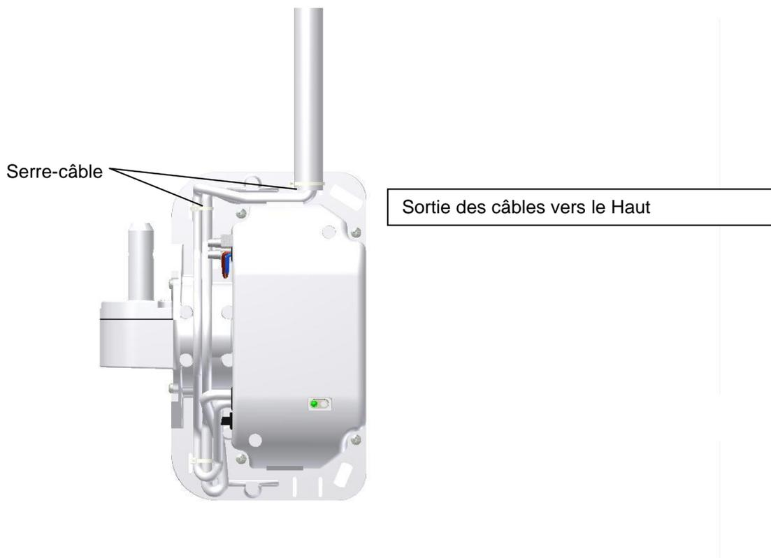
Mettre la gaine en bas de la platine, repasser les fils dans la gaine et fixer avec des serre-câbles.
