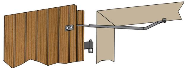
Système permettant l'entraînement des doubles vantaux.
