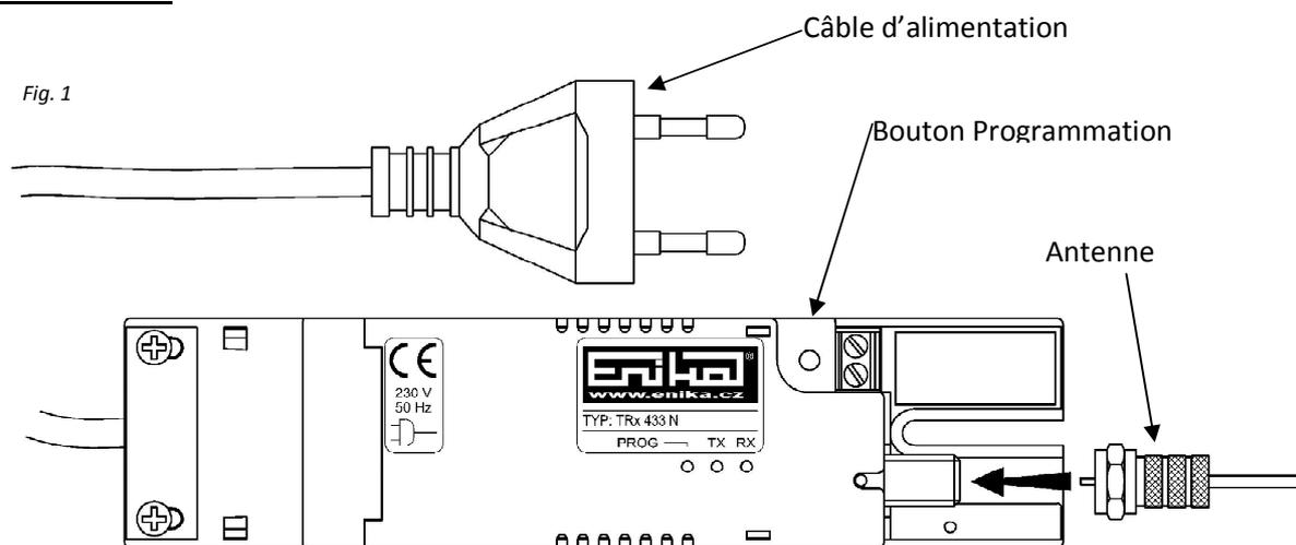
Le répéteur de signal (fig. 1) est utilisé pour faire fonctionner ensemble les émetteurs et les récepteurs radio de la série BOSys<sup>®</sup> utilisant le protocole de transmission EXM 433<sup>®</sup>, afin d'étendre leurs portées efficaces.
