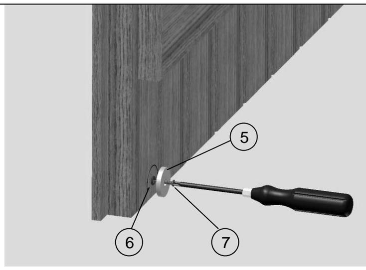
Positionner la plaque bien centrée sur le tracé Serrer la vis sans écraser le joint.
