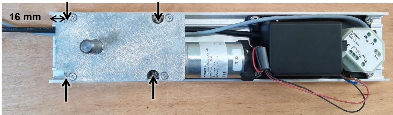
h. Câbler les fils du ou des moteurs et de l'alimentation sur le boîtier de commande. Attention à respecter la position d'avant le démontage.
